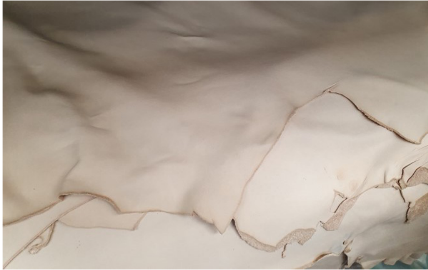
Figura 2. Pelle conciata con tecnologia LIFEGOAST. Il risultato è una pelle beige chiaro con caratteristiche adatte all'uso nel settore automotive.
